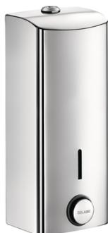
Modèle antivandalisme avec serrure et clé standard DELABIE. Distributeur de savon mural à déclenchement souple. Capot en inox 304 bactériostatique. Épaisseur inox : 1 mm. Contenance : 1 litre. Dimensions : 90 x 105 x 252 mm. Pour savon liquide à base végétale de viscosité maximum : 3 000 mPa.s. Compatible avec gel hydroalcoolique.
