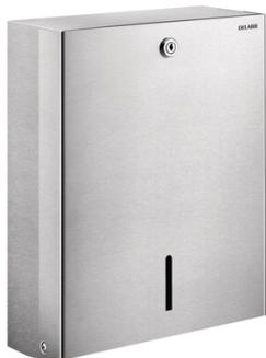
Distributeur d'essuie-mains mural. Inox 304 bactériostatique poli satiné. Système de distribution feuille à feuille adapté à la plupart des essuie-mains du marché. Avec serrure et clé standard DELABIE. Contrôle de niveau. Contenance : 500 formats. Dimensions : 120 x 275 x 360 mm. Possibilité de commander séparément un paquet d'essuie-mains enchevêtrés (réf. 6606). Garantie 10 ans.
