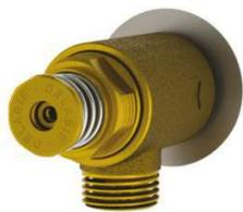
Temporisation ~7 secondes. Débit préréglé à 3 l/min à 3 bar, ajustable de 1,5 à 6 l/min. Corps en laiton brut. Raccordement M1/2". A poser derrière la plaque du lave mains. Garantie 10 ans.
