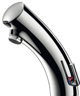
Alimentation par piles 123 Lithium 6 V intégrées. Electrovanne antistagnation et module électronique intégrés dans le corps de la robinetterie. Débit pré-réglé à 3 l/min à 3 bar, ajustable de 1,5 à 6 l/min.
