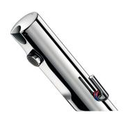
Alimentation par piles 123 Lithium 6 V intégrées. Electrovanne antistagnation et module électronique intégrés dans le corps de la robinetterie. Débit préréglé à 3 l/min à 3 bar, ajustable de 1,5 à 6 l/min. Brise-jet antitartre.
