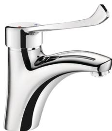
Cartouche céramique Ø 40. Butée de température maximale préréglée. Débit limité à 5 l/min à 3 bar. Fixation renforcée. Levier Hygiène L.150. Livré avec flexibles PEX F3/8".
