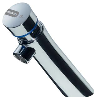
Pression d'utilisation recommandée : 1 à 5 bars. Débit : 3 l/mn à 3 bars, réglage 4 positions, dispositif anti-coup de bélier. Durée d'écoulement : 15 secondes  $\pm$  5 secondes. Alimentation hydraulique : Mâle G 1/2 (15x21).
