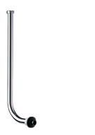
Pour TEMPOCHASSE apparent. Tube coudé Ø 32 avec écrou 1"1/4. Collier et nez de jonction Ø 32/55 à bride. Inox poli brillant L.205 mm, H.670 mm. Garantie 10 ans.
