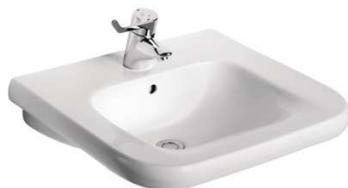
En porcelaine vitrifiée. Autoportant. Faible épaisseur pour un passage de jambes facilité. Rainure en partie inférieure pour approche facilitée en fauteuil. Grande largeur, bord droit anti-éclaboussure. Bord recourbé pour faciliter l'approche au lavabo. Avec trop-plein. Percé un trou central diamètre 35mm pour la robinetterie.
