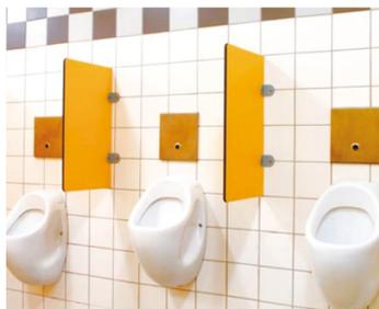
Séparation d'urinoirs fixée uniquement au mur par 4 équerres. Angles supérieurs et inférieurs arrondis. Hauteur 610mm et largeur 365mm
