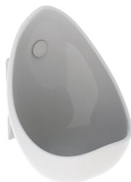
Pack Prêt à poser comprenant : un urinoir Aubagne 2, une bonde 1 1/4" à grille acier inox, un robinet 1/2" temporisé réglable, à alimentation apparente avec rosace et fixation, une tubulure d'alimentation avec effet d'eau, un siphon réglable à culot démontable, sortie Ø 32, un jeu de crochets de fixation.
