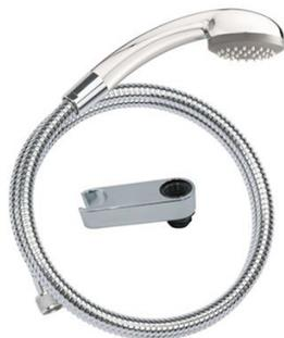
Ce kit de douche Cobra est équipé d'un pommeau de douche chromé avec jet pluie, picots anti-calcaire et diffuseur de diamètre 65 mm. D'un flexible de 1,75 mètre en métal chromé avec double agrafage et qui peut résister à une traction allant jusque 50 kg. Et d'un support mural à fixer sur la robinetterie en ABS chromé permettant de maintenir le pommeau de douche. Matière : ABS, Métal. Modèle : Cobra. Famille : kit douche.
