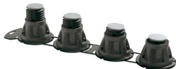
Pieds pour receveur de douche qui servent à ajuster le niveau de réglage d'un receveur de douche. L'embase du pied peut se fixer au sol par l'intermédiaire de 3 vis. La partie supérieure du pied est équipée d'un patin souple antidérapant. Charge de 450 kg par pied.
