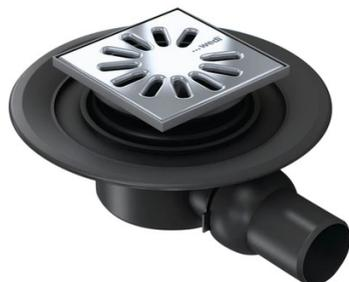
Kit Wedi Fundo d'écoulement en un point horizontal avec grille carrée, pour receveurs de douche Fundo avec écoulement en un point. Capacité d'absorption : 0,80 litre/seconde. Profondeur minimale d'encastrement : 130 mm.
