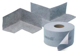
Bande d'étanchéité Wedi Tools se compose d'un tissu feutré en polypropylène enduit de TPE. Bande d'étanchéité pour le raccordement étanche des panneaux de construction Wedi et des receveurs Wedi Fundo à d'autres matériaux extérieurs au système (chape, plaque de plâtre cartonnée...)
