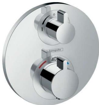
2 sorties = 2 fonctions. Contrôle du débit et inverseur pour 2 sorties. Débit maximal sous 3 bars de pression : 29 l/min. Débit de sortie supérieure : 28 l/min. Débit de sortie inférieure : 25 l/min. Cartouche thermostatique SMTC, robinet d'arrêt/inverseur. Butée de confort à 40° C. Limiteur de température réglable. Type de raccordement : corps d'encastrement.
