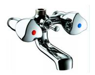
Mélangeur bain-douche, chromé avec têtes à clapet Long-Life. Bec fixe à brise-jet pour "échange-standard". Croisillons DELTA chromés. Corps en laiton chromé. M1/2", entraxe 80 mm.
