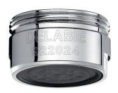
Sachet 2 pièces. Brise-jet antitartre préréglé à 3 l/min (brevet DELABIE). Débit réglable de 1,5 à 6 l/min à 3 bar (selon le modèle de robinetterie) par l'extérieur avec une clé Allen 2,5 mm. Brise jet sans grille, limite le développement bactérien : pas de rétention d'eau ni dépôt d'impuretés. F22/100. Livré par 2 pièces. Garantie 10 ans. Les économies d'eau permises par le brise-jet ECO sont supérieures aux exigences de la classe "Z" de la
