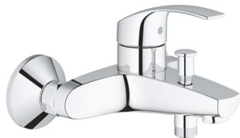
Cartouche céramique Ø 35 mm avec butée éco 1/2 débit. Clapet anti-retour intégré. Inverseur automatique pour 2 sorties.
