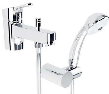
Bec long avec aérateur intégré. Inverseur à retour automatique tout métal. Sortie de douche par le dessous avec clapet anti-retour intégré. Cartouche Ø 47 mm à 2 disques céramique. Avec limiteur de température intégré et limiteur de débit 50 % déverrouillable. Flexibles d'alimentation 350 mm. Système de fixation rapide EASY-FIX. Avec set de douche comprenant douchette anticalcaire 1 jet pluie, flexible laiton 1,5 m, support douchette. Projection 156 mm
