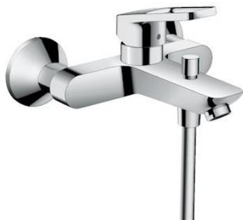
Mitigeur bain/douche C2 avec cartouche à 2 vitesses chromé. Longueur 180 mm. 2 sorties = 2 fonctions. Type de raccordement: raccords S. Entraxe: 150 mm  $\pm$  12 mm. Type de jet du mitigeur: jet normal. Débit maximal sous 3 bars de pression: 22 l/min. Cartouche céramique à 2 vitesses. Limiteur de température réglable. Inverseur avec réinitialisation automatique. Clapet anti-retour intégré. Avec silencieux. Convient au chauffe-eau instantané. E3/1, C2, A2, U3.
