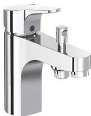
Mitigeur bain-douche monotrou Ulysse projection 129 mm Porcher. Bec long avec aérateur intégré, inverseur métal à retour automatique. Sortie de douche 1/2 par le dessous avec clapet anti-retour intégré. Cartouche diamètre 38 mm Firmaflow flexibles d'alimentation G3/8 PEX.
