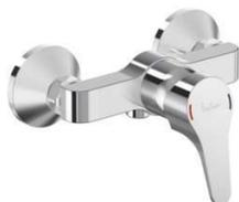
Mitigeur de douche mural NF Ulysse chrome. Sortie de douche 1/2" par le dessous avec clapet anti-retour intégré. Cartouche Ø 38 mm FirmaFlow® avec limiteur de température intégré. Raccords muraux. Poignées en métal.
