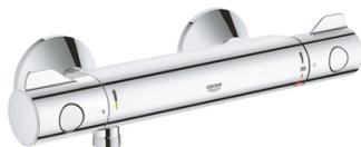
Mitigeur thermostatique douche. Butée 38°C + limiteur de température 50°C. Cartouche C3. Poignée de débit avec touche éco et butée éco réglable séparément. Filtres et clapet anti-retour intégrés. Tête céramique 1/2 180°.
