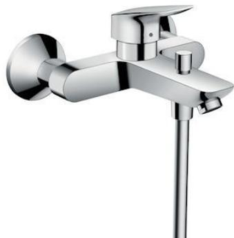
Mitigeur bain/douche C2 avec cartouche à 2 vitesses chromé. 2 sorties = 2 fonctions. Longueur : 194 mm. Entraxe : 150 mm +/- 12 mm. Type de jet du mitigeur : jet normal. Débit maximal sous 3 bars de pression : 22 l/min. Cartouche céramique à 2 vitesses. Limiteur de température réglable. Inverseur avec réinitialisation automatique. Clapet anti-retour intégré. Avec silencieux. Convient au chauffe-eau instantané. Type de raccordement : raccords S. E3/1, C2, A2, U3.
