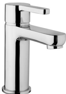
Mitigeur lavabo. Vidage laiton. Cartouche Ø 35 mm C3. 2 flexibles de raccordement inox 500 mm. Hauteur sous bec : 92 mm. Longueur de bec : 116 mm. Hauteur totale 150 mm.
