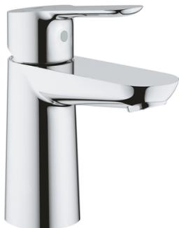
Monotrou sur plage. Levier de commande métallique GROHE Long-Life ES cartouche en céramique 28 mm avec économie d'énergie ouverture eau froide au centre GROHE Long-Life Shine Chrome éclatant et durable GROHE Water Saving mousseur 5 l/min. Système d'installation rapide Tirette et garniture de vidage 1-1/4". Flexibles de raccordement souples.
