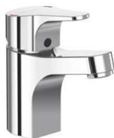
Mitigeur de lavabo Ch2 NF Ulysse chrome. Bec fixe. Aérateur avec limiteur de débit max 5 L/min. Cartouche Ø 38 mm FirmaFlow® Ch2. Avec tirette et vidage polypropylène. Flexibles d'alimentation PEX 3/8» 35 cm. Hauteur sous aérateur 8,3 cm. Hauteur totale 13,7 cm. Projection 10,3 cm.
