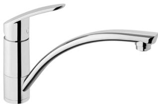
Cartouche avec disque céramique. limiteur de débit à 9 litres/min. maximum 12 litres/min (E0 / mesuré sous 3 bar). mousseur plastique.
