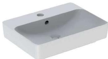
Vasque à poser Geberit VariForm rectangulaire, avec plage de robinetterie. Montage simple grâce au gabarit de découpe fourni. Installation sur plans ou meuble possible. Trou de robinetterie au centre. Trop-plein visible.
