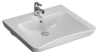
Conforma lavabo PMR, 600 mm, version standard, accessibilité aux personnes à mobilité réduite, selon DIN 18040, montage mural, avec trou pour robinet, avec trop-plein. Couleur : blanc brillant. Longueur : 600 mm. Profondeur : 545 / 510 mm. Hauteur : 165 mm. Poids : 16,6 kg.
