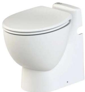
Possibilité de raccorder un lave mains. Ergonomique et design. Silencieux. Système Eco+ (double chasse 1,8/3 litres). Diamètre de refoulement conseillé : 32mm. Température moyenne des eaux usées entrantes : 35°C. Alimentation: 220-240V/50Hz. Clapet anti-retour fourni. Evacuation de vos eaux usées et vannes jusqu'à 3 mètres verticalement ou 30 mètres horizontalement. Débit : > 100 litres/min. Fixation au sol fournies.
