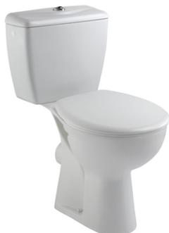
Abattant rigide avec charnières en plastique. Mécanisme de chasse économiseur d'eau 3/6 L. Robinet flotteur silencieux classe acoustique 1.
