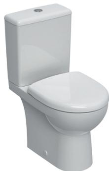
Cuvette Rimfree sans bride au sol, réservoir réversible. Pour alimentation latérale Compact Type 1, volume total 6 l, selon EN 997. Sortie multidirectionnelle. Pour alimentations en eau 3/8".
