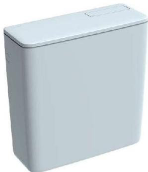
Réservoir attenant apparent Geberit AP128. Blanc Alpin Silencieux Rinçage double touche 6/9 L. Arrivée d'eau latérale à gauche ou à droite Livré avec fixations, joint EPDM et support entre le réservoir apparent et la paroi arrière.
