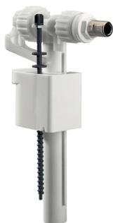
Robinet flotteur latéral compact certifié NF. Fermeture hydraulique (pas de coup de bélier). Silencieux classe acoustique 1 < 20 décibels. Anti-siphonnage.
