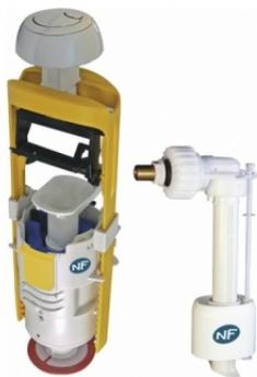
Mécanisme NF Universel à poussoir double débit. Montage simple et rapide. Pas de recoupe du trop-plein. Réglage télescopique. Bouton chromé. Fixation du couvercle possible. Passage dans couvercle : Sans rosace de 38 à 45 mm, avec rosace de 16 à 60 mm. Robinet flotteur compact, certifié NF classe acoustique 1, très silencieux. Alimentation latérale 3/8 en laiton. Fermeture hydraulique. Niveau d'eau réglable, compact, remplissage rapide 0.13l/sec. à 3 bars.
