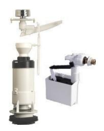
Mécanisme NF universel SIMPLEX à poussoir simple débit, montage simple et rapide, s'adapte par simple réglage de l?étrier à la plupart des réservoirs de 300 à 470 mm de hauteur interne.
