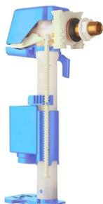
Robinet flotteur à remplissage différé, certifié NF classe acoustique 1, très silencieux, alimentation latérale 3/8" en laiton, fermeture hydraulique, niveau d'eau réglable, compact, remplissage rapide 0.15 l / sec à 3 bars. Avantages : Le robinet flotteur reste fermé pendant le vidage du réservoir : le remplissage démarre uniquement lorsque le volume d'eau est libéré. Résultat : jusqu'à 9 litres d'eau économisé.
