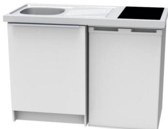
Corps portes et faces en bois mélaminé 16 mm. Caissons et portes réversibles. Étagère à l'intérieur du caisson. Pieds à vérin réglable en hauteur (de 0 à 15 mm). Table de cuisson : 2 feux vitrocéramique 1200 W + 1800 W. Touches sensibles et minuterie. Recouvrement avec évier inox 18/10.1 cuve avec vidage manuel inclus. Réfrigérateur 82 L, 48 cm avec dégivrage automatique. Freezer 8 L et porte et charnières réversibles.
