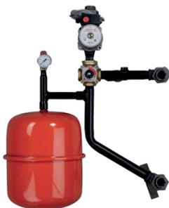
Composé d'un circulateur, d'une vanne mélangeuse 4 voies DN 20 mm, d'un circulateur chauffage, d'un vase d'expansion de 18 litres, d'une soupape de sûreté en diamètre 15 x 21 femelle, d'un manomètre et de bouchons si le circuit 2 n'est pas utilisé. Le raccordement des départs et retour chaudière sont en diamètre 26 x 34 femelle.
