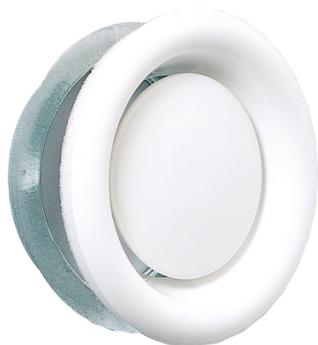
Les bouches d'extraction B-LK servent à l'extraction dans les bâtiments tertiaires. Les bouches d'insufflation BI-LK servent quant à elles à introduire l'air neuf dans les bâtiments tertiaires. Le réglage du débit se fait par simple rotation de l'opercule central. La gamme de bouches B-LK et BI-LK en acier recouvert de peinture epoxy blanche se fixent par rotation 1/4 de tour dans une colerette en acier galvanisé fournie. Elles peuvent être montées dans des manchons longs à griffes de type MB.
