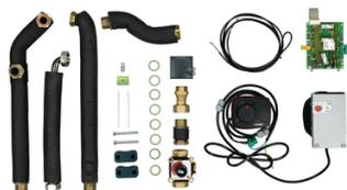
Cet accessoires est indispensable lorsque 2 niveaux de température distincts doivent être maintenus. Solution compacte, isolée. Fonctionnement réversible. Loi d'eau induite sur la zone plancher. Livré avec : Circulateur basse consommation, vanne 3 voies motorisée, sonde de départ, vannes/thermomètres.
