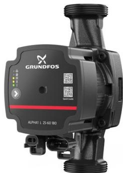
Circulateur à vitesse variable à haut rendement énergétique. Indice d'efficacité énergétique inférieur à 0,23. Consomme uniquement 81 kW/an (pour une habitation de 150 m<sup>2</sup> avec 6840 h de chauffage/an). Connecteur électrique embrochable pour une installation simplifiée. Adaptable aux installations neuves ou anciennes (monotube ou bitube). Affichage LED de la consommation. Modes de contrôle multiples.
