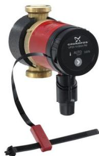
Circulateur pour installations d'eau chaude sanitaire. Equipés d'un moteur sphérique contrairement qui facilite le démontage pour l'entretien des circulateurs : dépôts calcaires. Faible consommation électrique, mesure en continu les variations de l'installation afin d'optimiser le démarrage/arrêt du circulateur et assure périodiquement un cycle "haute température"\* du circuit (légionellose). Entraxe 140 mm. Certifié ACS.
