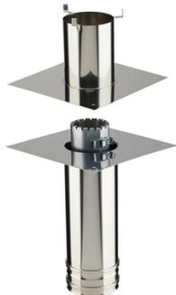
Permet la rénovation et l'adaptation d'un conduit traditionnel carré départ plafond au système PGI. Les fumées sont évacuées dans un tubage flexible, l'air comburant est acheminé par la lame d'air située entre le tubage et le boisseau.
