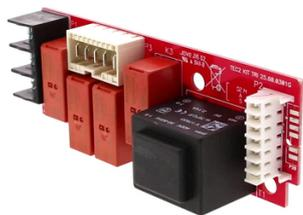
Installation facile : il suffit de déclipser la carte mono en place après avoir déconnecté le faisceau électrique de la résistance et de la remplacer par le kit
