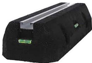
Les supports Rubber traditionnels permettent de supporter de grosses charges. Ils sont équipés d'une barre d'aluminium moulée de 40 mm dans la base ainsi que de plusieurs niveaux à bulles. Fabriqués à base de pneus recyclés, ils sont anti-vibratiles, efficaces et économiques. Livrés avec visserie.
