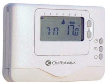
Easy Control Bus réunit les fonctions d'un thermostat d'ambiance et d'un programmationmètre, permettant ainsi de définir des périodes où le chauffage est allumé et d'autres où il ne l'est pas, en fonction de votre rythme de vie.
