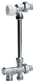
Robinet thermostatisable complet avec canne et distributeur 4 voies droit 1/2" x 18, mono/bitube (\* Livré en version bitube). Capuchon de protection. Nickelé, à raccord à compression pour tube P.E.R. ou CUIVRE (livré sans raccords voir page 51). 3625N - 18 ou 3015N - 18. Composants: - 1 x 810P - 1 x 0914T Ø 15 - 1 x 930 - 2 x 3525N Ø 15
